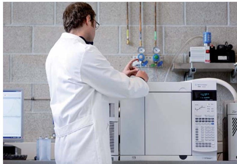
Analyse von Alterungsprodukten am Gaschromatograf mit Massenspektrometer
