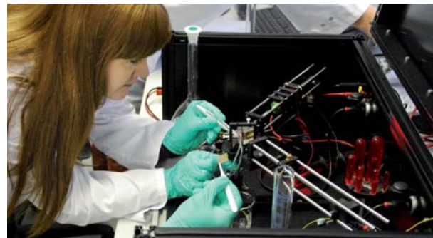
SPR-Referenzmessplatz (bestehend aus Lichtquelle, Sensorchip, Mikrofluidik und Detektor) wird mit einem neuen Sensorchip bestückt
